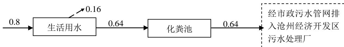
图 3.4-1 全厂水平衡图 (单位: \text{m}^3/\text{d} )
