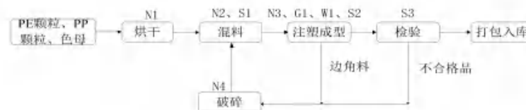
图 3.6-1 料盘生产工艺流程及排污节点图
