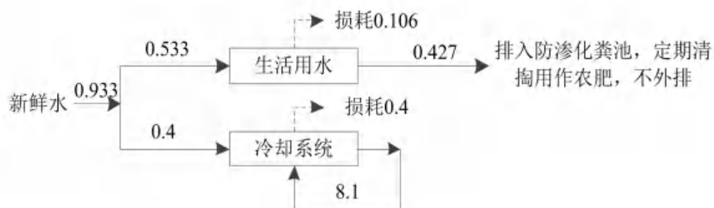
图 3.5-1 扩建工程水平衡图 单位： \text{m}^3/\text{d}
