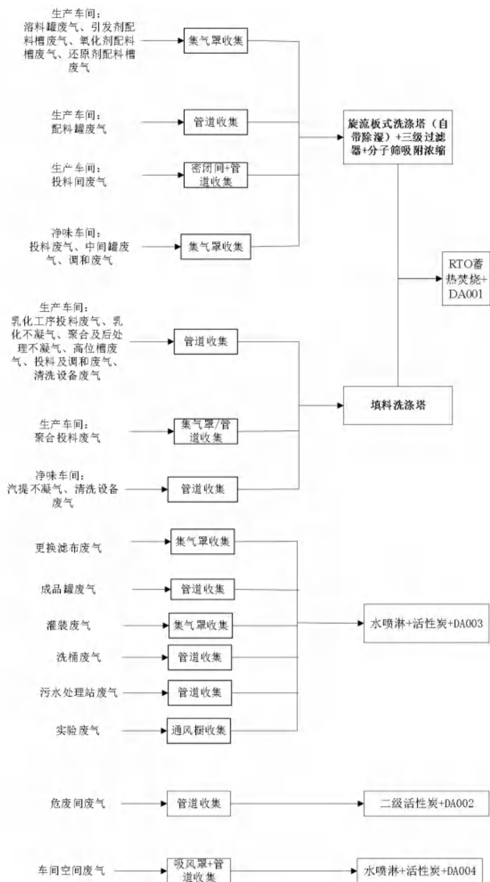
图 4.2-3 废气收集处理示意图
